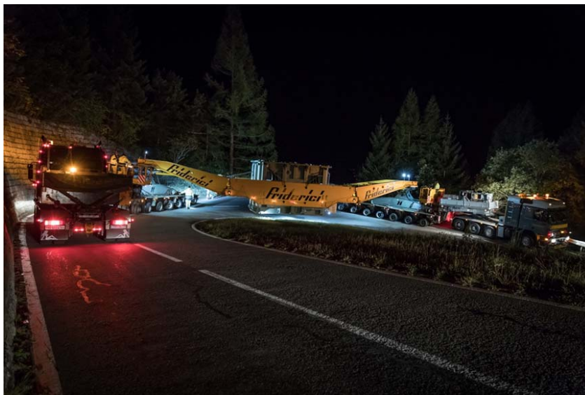
Spezialtransport Maschinentransformator am Col de la Forclaz
